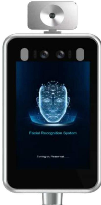
Nessun impegno di operatore si installa su cavalletto alle entrate degli edifici. Possibilità di generazione di allarme su superamento soglia temperatura impostata. Nessuna supervisione da remoto
